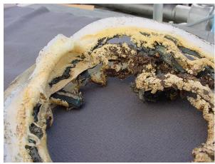
ゴア™トライガード®ガスケットにおいてもモノマーの浸透は避けられず、半永久的な使用は不可能です。しかし、ガスケット全体がPTFE製のためPTFE被覆ガスケットに比べて破壊までの寿命が何倍も長くなります。したがって、定期的に交換をされる箇所であれば、モノマーに使用することが可能です。また、従来のPTFE被覆ガスケットと違って、ゴア™トライガード®ガスケットはなじみ性に優れた特殊なバリアメンブレンで被覆しているため、先の例のようなフランジとガスケットの界面での重合が起こらず、短期間でガスケットが問題を起こすといったアクシデントがなくなります。
