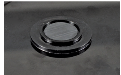
正しい配置: ベントが完全にターゲットフレームの壁の内側に収まっています。
