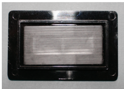
ガイドにめり込んでしまったベント／有効通気部がハウジングの孔に押し込まれたベント
