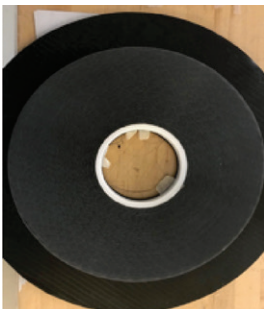
新品のベントロール：適切な張力で巻き取られているので、欠損がありません。
