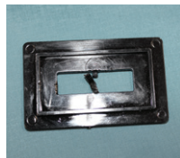
損傷したベント取り付け部
