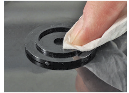
ベントハウジング（取り付け部）は必ず事前にクリーニングしてください。
