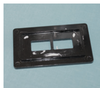
ベント取り付け部に付着している異物
