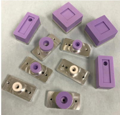
いろいろな形状とサイズの粘着材付きゴア® オートモーティブベントにマッチした、ゴア製機械的加圧ヘッド
