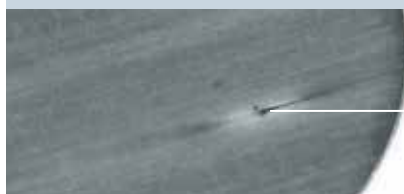
図1 不合格…ベントに ピンホール
