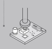
**5.** : ノズルが所定の位置に移動し、 ハウジングを装着します。
