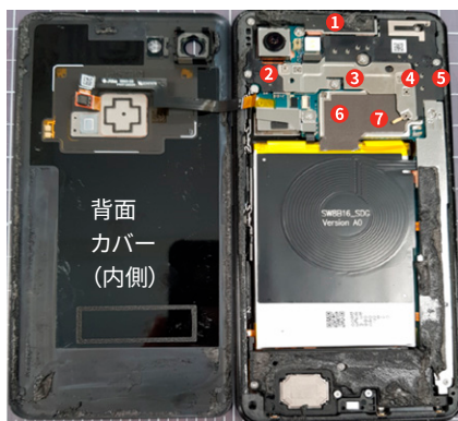
図9：Google Pixel 3XLの背面カバーを外した状態。図に示す7か所で、形状追従性ポリマーにより既存の空隙の厚さを測定した。
