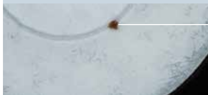
図2 不合格…メンブレンに0.7mm 2 を超える除去不可能な異物
