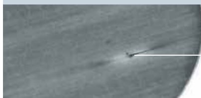
図1 不合格…ベントにピンホール
